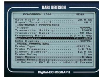
2. ジョグダイヤルを回してRectificationの項目にカーソルを合わせます。
