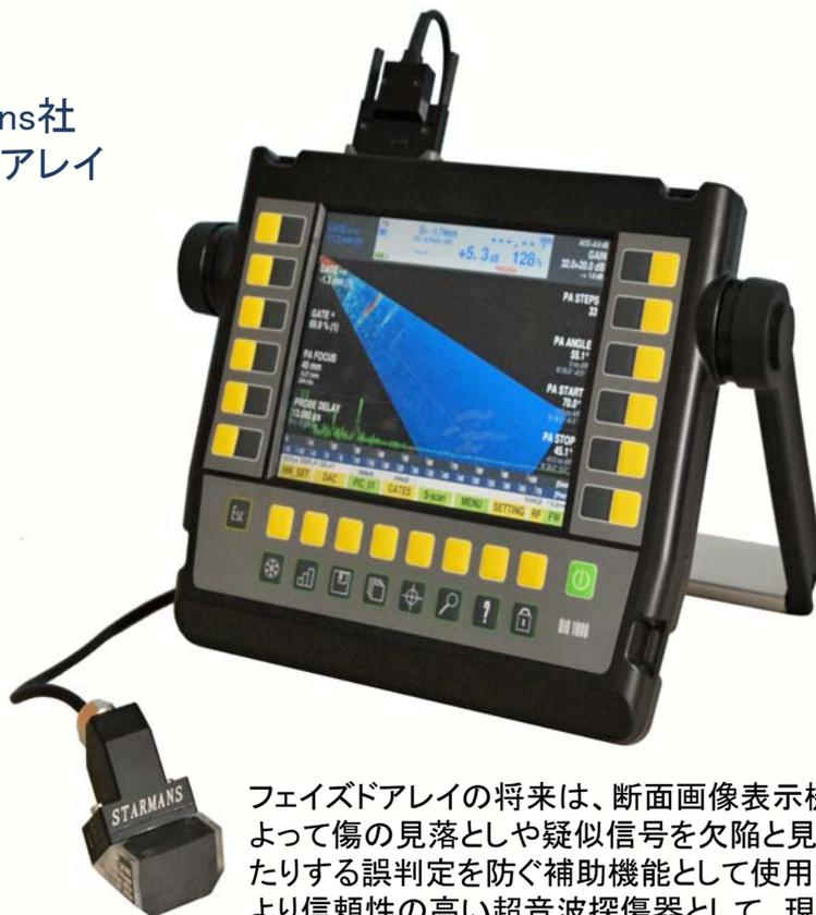
最新のDIO1000PAはフェイズドアレイの演算、解析、表示機能を備えています。標準の探傷器としても使用できるパワフルユニットです。最新の電子部品とマイクロプロセッサを採用し、厚さわずか34mmの最も軽量、小型を実現しています。標準規格EN12668-1, ASME2541, ASTM E2491 / E2700に準拠しています。総合感度111dB, ADサンプリング200MHz、縦軸分解能12bitの高性能機です。
