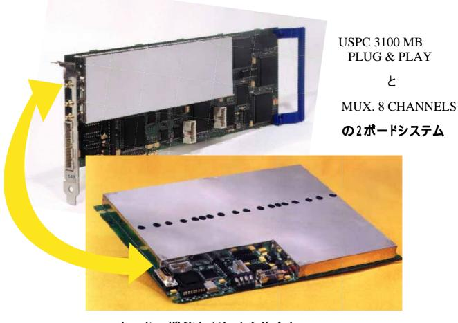
USPC 3100 PCI カードの機能とメリットを生かして、 多チャンネルシステムに拡張するボードです。
